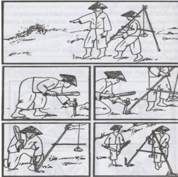
Gambar 29. Teknik Pembuatan Kontur dengan Kerangka A
